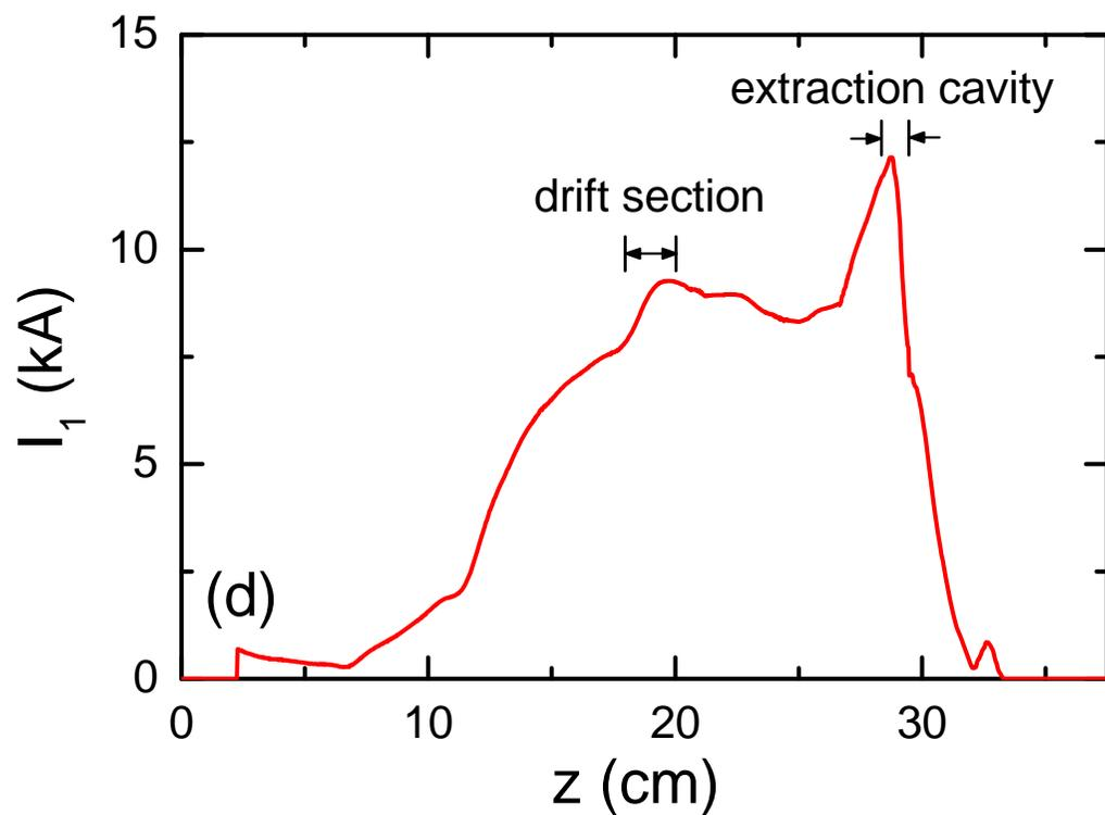
在最后一个慢波结构处快速上升，在提取腔处达到最大
