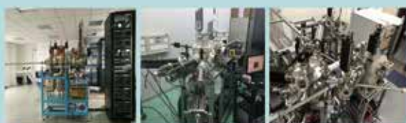
光阴极制备系统（极高真空蒸镀-10Pa）
